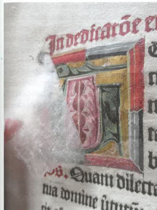
14. kép. A poli-vinil-butiro-acetál film lefejtése a ciklododekán szublimálása után
